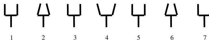
Рисунок 11. Схематическое изображение смещения усов камертона за полтора колебательных цикла.
